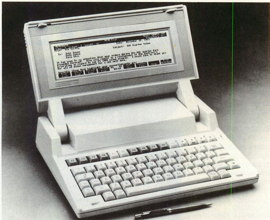
Foto 1 - La magnifica compattezza di "The Portable". Si notino gli incavi in cui si inseriscono ad incastro le sporgenze del display reclinabile. Sullo schermo è in azione Memomaker, un semplice word processor. Il punto di forza nel software congelato nei ben 384 Kbyte di ROM è il superpackage Lotus 1-2-3. La RAM non volatile CMOS si estende invece su 272 Kbyte ed è configurabile in parte come "disco statico al silicio".
