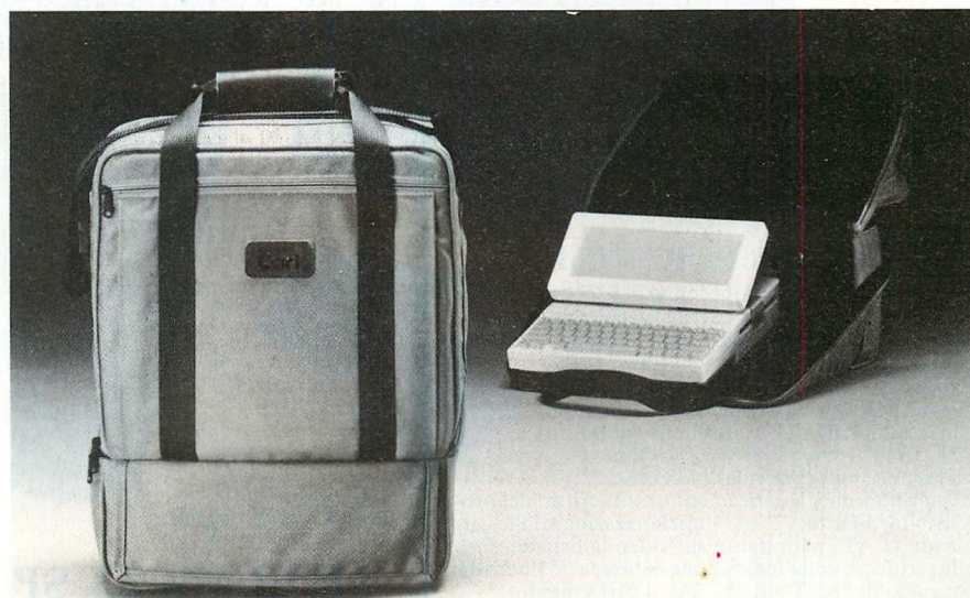
Foto 4 - Ora l'Apple IIc è veramente portatile. La Dischwasher ha introdotto una "stazione di alimentazione portatile", la Cari, inglobata in una borsa, all'interno della quale si può inserire l'Apple IIc con monitor a LCD, trasformando il tutto in una comoda valigetta-ufficio portatile. Il peso complessivo è di soli 9 Kg circa e le batterie della Cari possono funzionare da tre a cinque ore. Quando il IIc è collegato a rete il Cari può anche funzionare come batteria tampone.
