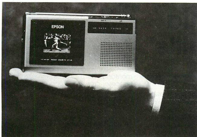
Foto 11 - La Epson è entrata nel mercato dell'elettronica di consumo con un prodotto che non ha niente a che vedere con la sua normale produzione: un televisore a colori, schermo piatto LCD. Sviluppato grazie ad un nuovo tipo di cristalli liquidi, con una risposta più veloce agli impulsi elettrici, l'Epson Elf è il primo TV LCD a colori del mondo.
