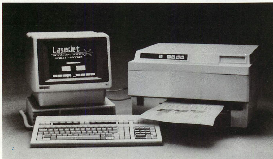
Foto 3 - Questa è invece Laserjet, stampante laser costruita secondo la tecnologia Canon. Il suo prezzo di 7 milioni rende accessibile a più vaste schiere d'utenti questa tecnica di stampa bitmap ad elevata risoluzione e silenziosità. L'alimentatore per fogli di formato standard è in un cassetto simile a quelli delle piccole fotocopiatrici (sotto il foglio, nella foto). Aprendo sul fianco destro uno sportello si può agevolmente sostituire una grossa cartuccia elettrofotografica racchiusa in un contenitore di plastica.. Dura un tremila pagine A4.
