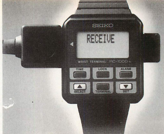
Foto 5 - Un terminale da polso? Ora non è più fantascienza, ma realtà con il nuovo RC-1000 della Seiko. Si tratta di un'ingegnosa estensione del personal computer, che consente di immettere dati direttamente dal proprio computer per utilizzarli quando necessario. Ha una capacità di memoria di 2 Kbyte e un tempo di trasferimento dati di 10 secondi.
