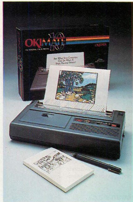
Foto 10 - La Okidata ha presentato la sua prima stampante per il mercato degli home computer. Si chiama Okidata 10 ed è una stampante a colori, che implementa la tecnologia di stampa a trasferimento termico, pur stampando su qualunque tipo di carta. Può addirittura stampare su acetato. È interfacciabile con i computer Commodore e Atari.
